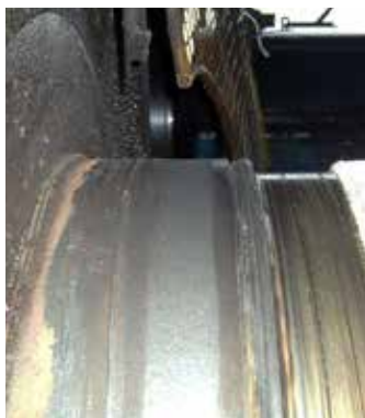
Уплотнительная поверхность после ремонта
