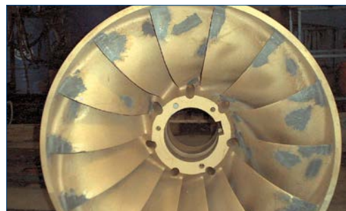
Идет нанесение Belzona 1341 (Supermetalgilde) на рабочее колесо
