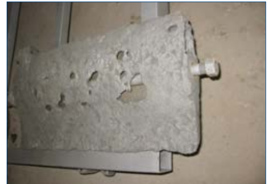
Направляющий аппарат после абразивной обработки
