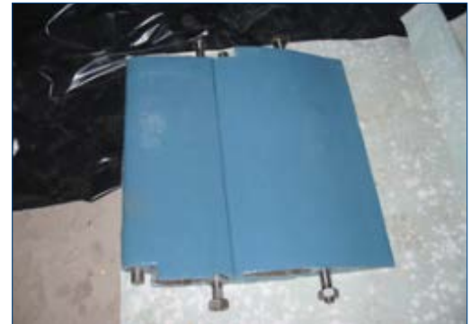
Лопатка покрыта материалом Belzona 1341 (Supermetalgilde)
