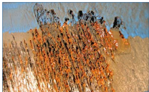
Рис. 1: Кавитационные повреждения колонны статора
