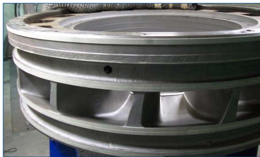
Рабочее колесо после пескоструйной обработки перед началом ремонта
