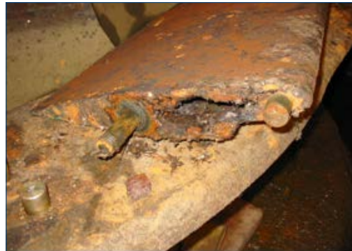
Поврежденная лопатка направляющего аппарата
