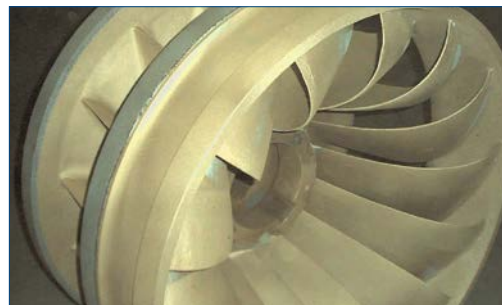
Турбина Фрэнсиса после абразивной обработки
