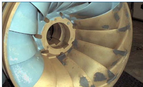
Турбина после восстановления с помощью пастообразного материала, которым заполнили эрозионные повреждения
