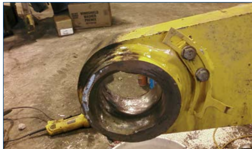
Поврежденный корпус центрирующей втулки
