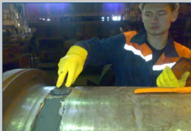
Для обеспечения соосности установлен временный вал
