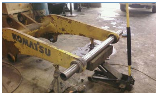
Для обеспечения соосности установлен временный вал
