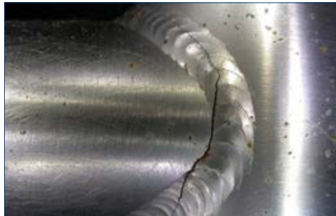
Рис. 2: Трещина в сварном шве из-за местных напряжений
